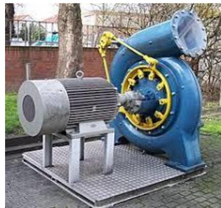
La Francis è *una turbina ad ammissione totale*, in quanto l'acqua investe contemporaneamente tutte le pale della girante, creando una spinta simmetrica; l'ingresso dell'acqua alla girante è radiale, mentre lo scarico è assiale. La geometria e le dimensioni della girante sono estremamente varie, essendo queste determinate da parametri che possono differire notevolmente a seconda dei siti di installazione.
