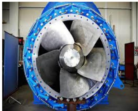
Per la realizzazione di questa turbina prese ispirazione dalla preesistente elica idraulica, alla quale apportò delle migliorie che consentirono, mediante un meccanismo di sua invenzione, la regolazione del passo dell'elica.
